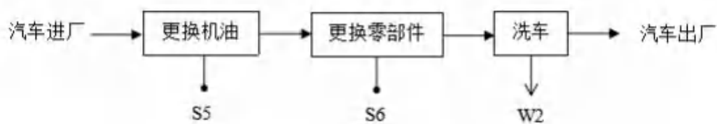
图 5-2 汽车保养工艺流程及产污环节
