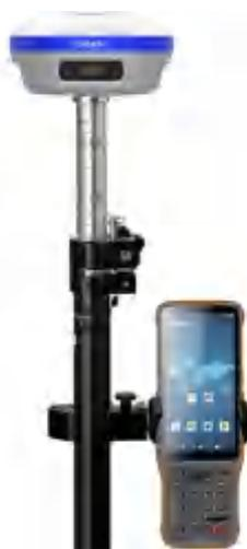
图 5.1-1RTK 测量系统
