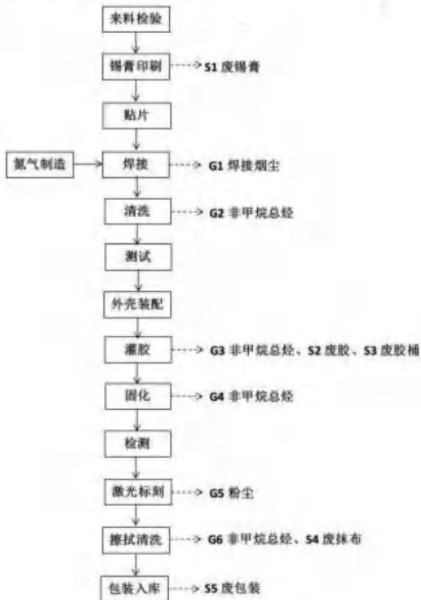
图 5-1 模块生产测试工艺流程图
