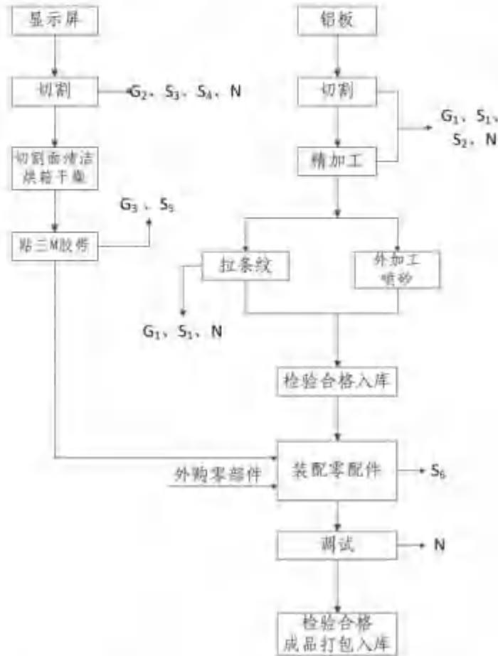
图 5-1: 无纸化智能办公系统和智能灯光升降系统生产工艺流程图
