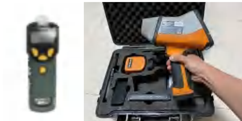
图 3-7 手持式 PID（PPbRAE3000）检测仪与 XRF（OlympusElement）检测仪
