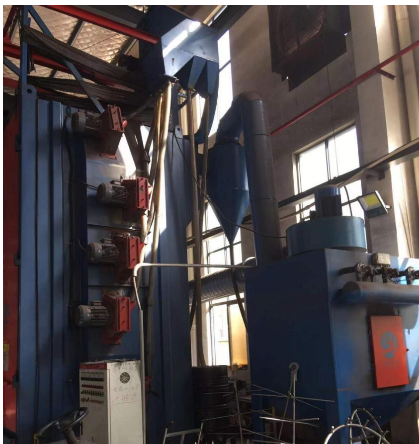
设备自带旋风除尘器+脉冲布袋除尘器
