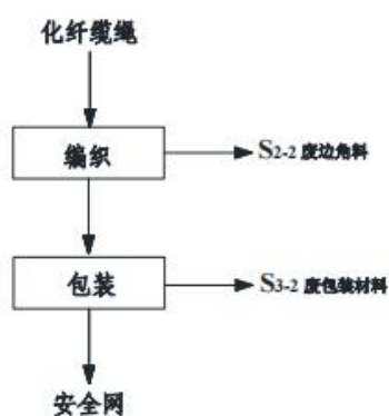
图2-2 安全网生产工艺流程及产污环节图
