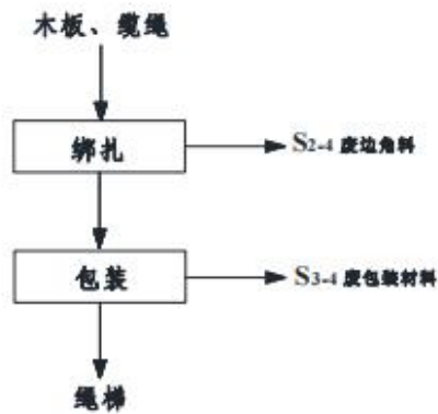
图 2-4 绳梯生产工艺流程及产污环节图
