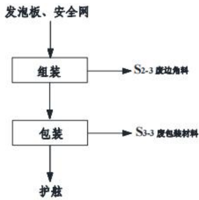
图2-3 护舷生产工艺流程及产污环节图
