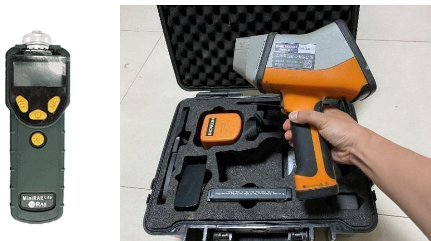
图 3-7 手持式 PID (PPbRAE3000) 检测仪与 XRF (OlympusElement) 检测仪
