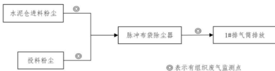
图 3-5 粉尘废气处理流程（含废气监测点位）
